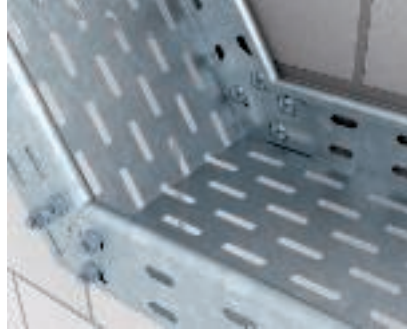
Réalisation de décalage ascendant ou descendant en hauteur Une fois les longerons latéraux entaillés, les chemins de câbles sont pliés manuellement dans un angle approprié compris entre 0 et 60° et fixés au moyen de l'éclisse droite RLVKV 60 FS. Une entaille de la tôle de fond n'est pas nécessaire.
