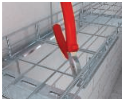
Éclissage droit sans vis avec raccords rapides Réalisation d'un éclissage sans vis de chemins de câbles en treillis à l'aide de l'éclisse rapide GRV.
