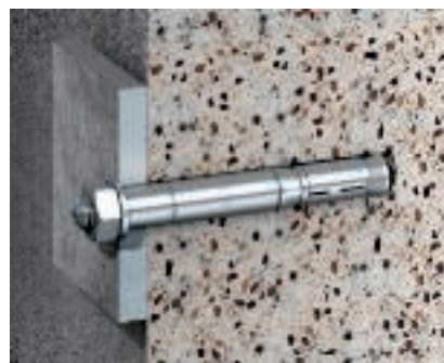
Cheville d'ancrage pour charges lourdes type SZ Cheville d'ancrage pour charges lourdes type SZ avec raccord fileté M12, pour la fixation de composants soumis à de fortes sollicitations, autorisée pour le béton normal C20/25 à C50/60 fissuré ou non fissuré.
