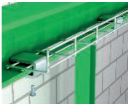
Montage d'une équerre en treillis Fixation de l'équerre en treillis GW 40/80 sur les poutres métalliques avec des pièces de serrage de type KL 20 ou KL 30.
