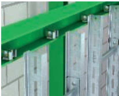
Fixation de montant en I sur poutre métallique Fixation de l'échelle verticale industrielle de type SLS 80 sur une poutre métallique avec la griffe TGK 30/42.
