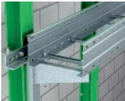
Console murale lourde Montage de la console murale lourde AWSS avec un crapaud de serrage KWS sur une poutre métallique pour accueillir un système longue portée. Le montage de la console murale peut également être effectué sur des murs en béton avec des chevilles d'ancrage.
