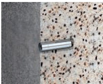
Cheville d'ancrage type E Cheville d'ancrage de type E taraudée M8, M10, M12. Pour réception de petites charges, autorisée pour fixations multiples de systèmes dans du béton fissuré et non fissuré de systèmes non porteurs.
