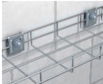
Fixation murale de chemins de câbles en treillis Fixation murale de chemins de câbles en treillis avec support mural de type K 12 1818. Largeur maximale des chemins de câbles 200 mm.
