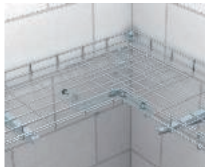
Réalisation d'un coude de chemins de câbles en treillis - angulaire, chevauchant Après la coupe appropriée des chemins de câbles en treillis, ces derniers peuvent être assemblés en un coude de chemin de câbles en treillis angulaire non chevauchant à l'aide des éclisses couvre-joints GSV 34 et d'un feuillard coudé.
