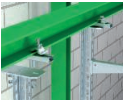
Fixation par crapautage avec profilé en C supplémentaire Utilisation d'un rail profilé en C supplémentaire de type CPS pour les poutres métalliques plus larges. Cheminement longitudinal à la poutre métallique.
