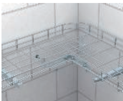
Réalisation d'un coude de chemins de câbles en treillis - rond, chevauchant Après la coupe appropriée des chemins de câbles en treillis, ces derniers peuvent être assemblés en un coude de chemin de câbles en treillis rond non chevauchant à l'aide des éclisses couvre-joints GSV 34 et d'un feuillard coudé.
