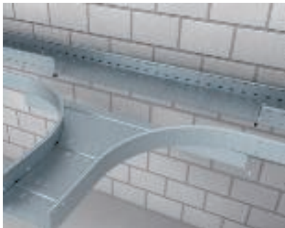
Montage d'une dérivation à assembler Dérivation en association avec les chemins de câbles longue portée. Le longeron latéral est séparé pour le montage.
