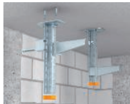
Montage standard, pendard avec console à talon unilatérale avec entretoise Fixation au plafond d'un pendard avec fixation unilatérale de la console. À partir d'une largeur de 400 mm, il est recommandé d'utiliser une entretoise.
