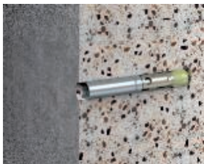
Goujon d'ancrage type BZ-IG La cheville d'ancrage BZ-IG taraudée est homologuée pour des trous normaux et non contredépouillés. Dans le cadre de l'Agrément technique européen ETA-99/0010 pour béton fissuré ou non fissuré, il est possible d'utiliser des vis à six pans et des vis à tête fraisée ainsi qu'un système à base d'écrou, de rondelle et de tige filetée courante.
