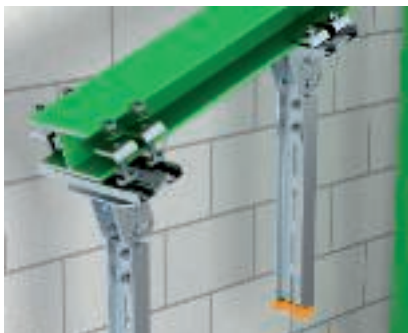
Application sur poutre métallique inclinée Fixations par crapautage à des poutres métalliques (IPN) inclinées à l'aide de crapauds et de griffes de serrage.
