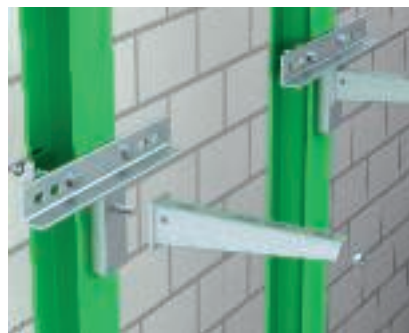
Fixation par crapautage sur poutres métalliques (IPN) verticales Montage de la plaque d'adaptation KA-AW sur une poutre métallique verticale à l'aide de crapauds de serrage ou de griffes de serrage. Les consoles murales AW sont fixées à la plaque d'adaptation avec la vis à tête hexagonale de type SKS 12x40 GF.
