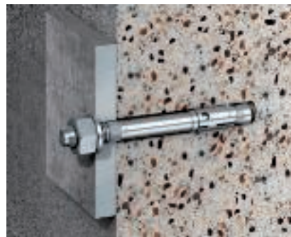
Goujon d'ancrage type BZ Chevilles d'ancrage de type BZ, pour la fixation de charges lourdes dans du béton normal fissuré ou non fissuré de types C20/25 à C50/60, compatibles pour le montage traversant, avec filetage M8, M10 ou M12.
