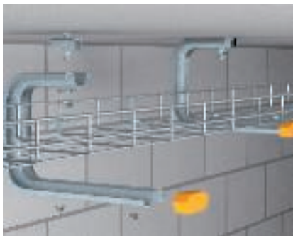
Montage au plafond avec console murale et de plafond de type TP Montage au plafond d'un chemin de câbles en treillis avec console murale et de plafond de type TPDG. La fixation du chemin de câbles en treillis s'effectue sans vis sur le support de plafond.
