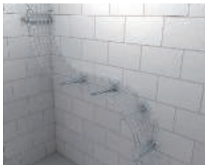
Coudes concaves et convexes Il est possible de réaliser des coudes verticaux concaves et convexes en entaillant une maille sur deux de l'aile du chemin de câbles en treillis.
