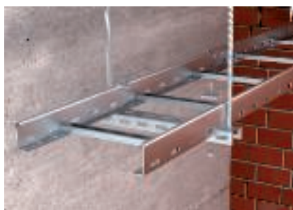
Montage sur profilé transversal avec pièce de serrage, boulons TRCC et grandes rondelles
