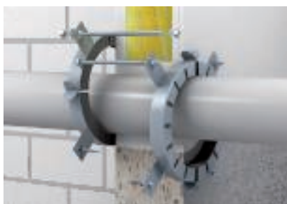
Installation excentrée des colliers - pour tube de diamètre inférieur au collier, différence maximum de 3 niveaux
