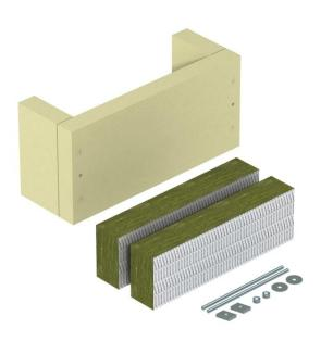
Décharge de traction en tant que mesure de supportage efficace pour le câblage vertical selon DIN4102 partie 12, homologuée pour tout type de câbles et tous les systèmes de pose verticaux. Classes de maintien en fonction E30 à E90. Boîtier avec plaques en fibres minérales, matériel de fixation, cartouche avec enduit coupe-feu ASX et plaque d'identification.
