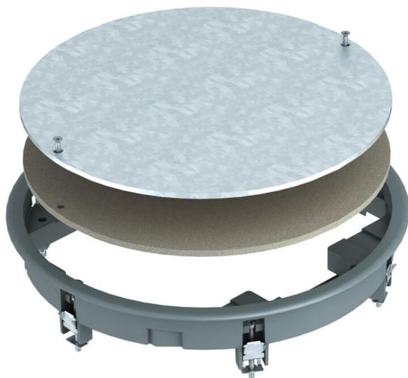
Trappe d'inspection pour l'obturation d'une ouverture de montage ronde de dimension nominale R7 dans les systèmes de goulottes et dans le faux-planchers et planchers creux en intérieur. Avec équerre de fixation universelle. Cadre de protection de moquette en polyamide.
