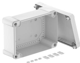
Boîtier de dérivation pour le raccordement de câbles et conduits en intérieur et en extérieurs protégés. Forme rectangulaire sans ouvertures. Convient pour le montage au mur / au plafond avec possibilité de fixation extérieure, de fixation intérieure ou de montage sur les dômes d'angle. Particulièrement résistant aux chocs avec IK08. Couvercle avec fermeture rapide, plombable. Fabriqué à partir de matériaux sans halogène et résistant aux UV.
