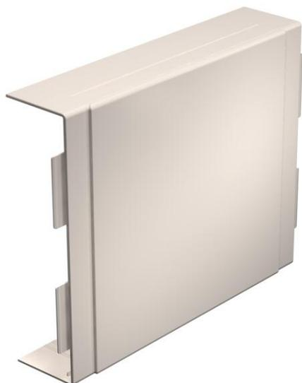
Pièces en T et en croix pour changer la direction des gouttes WDK. La pièce de forme est pré-perforée sur le côté pour relier différentes sections de goutte. Les pièces de forme se positionnent par recouvrement.
