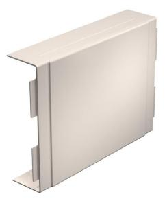
Pièces en Té et en croix pour changer la direction des goulottes WDK. La pièce de forme est pré-perforée sur le côté pour relier différentes sections de goulotte. Les pièces de forme se positionnent par recouvrement.
