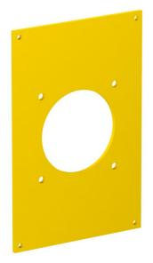
Plaque de recouvrement avec une ouverture de 70 mm de diamètre pour le montage d'une prise de courant CEE 16/32 A avec bande de fixation de 60 mm, incluant 4 vis pour la fixation de l'appareillage.
