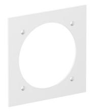
Plaque de recouvrement avec une ouverture de 70 mm de diamètre pour le montage d'une prise CEE 16/32 A avec entre-axe de 60 mm, 4 vis de fixation incluses
