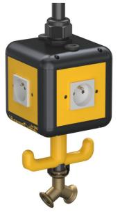
Boîtier équipé et précâblé avec 1 m de tuyau 1/2" et raccordement pour flexible d'air comprimé 13 x 3,5 mm et distributeur 2 voies 1/2", avec oeillets de suspension, poignée crochet et 4 plaques de recouvrement.
