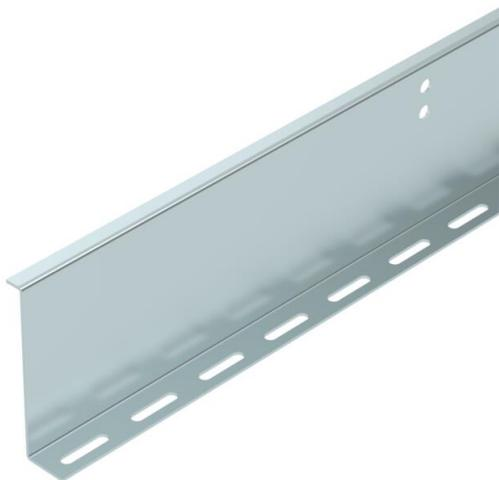
Séparateur pour système de chemins de câbles praticables BKRS. Fixation au moyen de boulons TRCC M 6 x 12 mm dans fond perforé.
