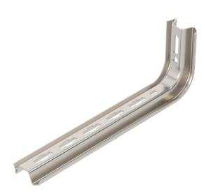
Montant / console TP à fixer sur les plafonds en béton horizontaux et aux murs. Si le profilé est fixé au plafond ou s'il est vissé contre la tête pour la renforcer, il convient pour des raisons de stabilité d'utiliser systématiquement l'entretoise de type DS 4.
