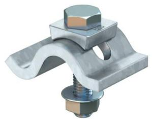
Crampon de serrage avec écrou pour la fixation directe de constructions sur poutres métalliques (IPN). La plage de serrage de la griffe de serrage est limitée à 25 mm maximum.
