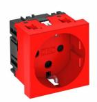
Prise de courant à contact de protection simple 0°, version codée, avec protection renforcée contre les contacts accidentels, avec bornes à fiche, 2 pôles, 16 A, 250 V~, avec bornes de raccordement selon CEI 60884-1.
