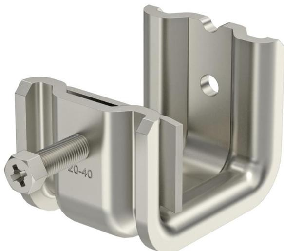
Ce type de pince de fixation est poussé sur le support et fixé sur le support ou un fer plat au moyen d'un patin de pression et d'une vis (M8). La vis hexagonale est dotée d'une cote sur plat de 10 mm. En outre, dans le corps de bride, deux autres filets M8 sont prévus pour fixer entre autres des tiges filetées.
