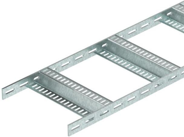
Échelle à câbles, version navale, avec longeron latéral perforé d'une hauteur d'aile de 40 mm, avec échelons en Z soudés et perforés, ouverts vers le bas. Charge testée selon CEI en combinaison avec les éclisses de type SLV.
