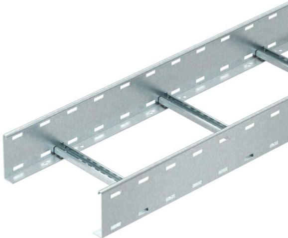
Échelle à câbles d'une hauteur d'aile de 110 mm avec échelons soudés à profilé C30 ouvert vers le haut. Longeron latéral enroulé pour le renforcement et la protection des bords. La fixation sur console s'effectue avec des pièces de serrage de type LKS 40. La fente de l'échelon mesure 16,5 mm. La bride de fixation correspondante est de type 2056.
