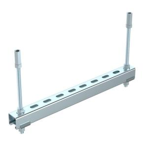
Matériel de suspension et de fixation en acier pour la réalisation du premier support d'installations effectuées de cloisonnements coupe-feu. Montage du pendule avec tiges filetées sous plafond. Il est possible de monter deux couches maximum avec des manchons de raccordement de deux kits. Les structures de support doivent être disposées sur les deux côtés du mur, en respectant d'écart prescrit pour le système de cloisonnement.
