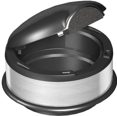
Couvercle de protection à fixer sur les boîtes de tirage sous chape UDL2-80 et les sorties sous chape, pour la protection de la sortie de câble dans des planchers à entretien humide à l'intérieur, avec bague en polyamide renforcée par nervures masquée par une bague en acier inoxydable V2A et joint d'étanchéité en caoutchouc.
