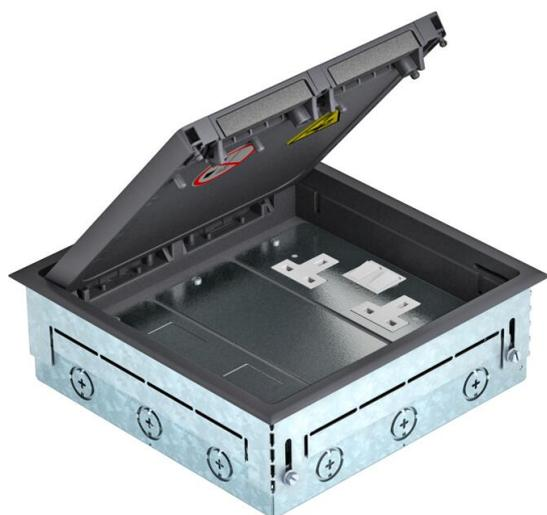
Boîte sous chape carrée pour un boîtier de sol GES9 UGE pour installation sous chape en intérieur. Avec ouvertures d'insertion défonçables pour tubes (M25), sur les quatre côtés. Avec trois plaques de recouvrement. La hauteur d'encastrement est de 64mm au minimum, la hauteur de nivellement 23mm. Trois plaques de recouvrement sont fournis dans la livraison: un modèle plein, une avec prise BS double couplée et une pour la pose de quatre prises de données femelle de type LJ6UC.
