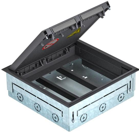
Boîte sous chape carrée avec boîtier de sol GES9 UGE pour installation dans des chapes en intérieur. Avec ouvertures d'insertion prédécoupées pour canalisations (M20/M25), sur les quatre côtés.
