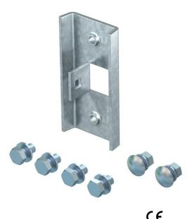
Support pour la fixation des échelons de type MS4022 dans les montants IS 8. Chaque kit comprend 2 supports d'échelon, 2 vis à tête hexagonale M8 x 16 mm et 4 vis à tête hexagonale M10 x 25 mm.
