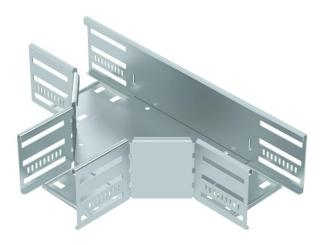
Pièce en T pour créer une dérivation horizontale, pièce de forme pour chemins de câbles encliquetables et vissables d'une hauteur d'aile de 85 mm. Montage sans vis avec bornes doubles ou raccord vissé avec vis à tête bombée FRS et écrous à rondelle sertie M6. Utilisable en intérieur. Le matériel de fixation doit être commandé séparément.
