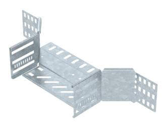
Dérivation à monter pour créer une dérivation horizontale ou une croix, pièce de forme pour chemins de câbles encliquetables et vissables d'une hauteur d'aile de 85 mm. Montage sans vis avec bornes doubles ou raccord vissé avec vis à tête bombée FRS et écrous à rondelle sertie M6. Utilisable en intérieur et en extérieur. Le matériel de fixation doit être commandé séparément.
