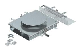
Unité d'extension de conduit prête à monter avec un couvercle de montage d'appareillage pour un boîtier de sol de taille nominale R9, composée d'un socle (plaque de sol avec profilés latéraux et d'insertion de revêtement de sol), d'un couvercle avec ouverture de montage obturée et d'un embout. 3 équerres de fixation réglables en hauteur, 3 chevilles à expansion pour béton, 1 support de contact de couvercle et 1 kit pour angle de dérivation sont fournis à la livraison.
