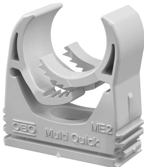
Collier en saillie pour la fixation de tubes métriques et de tubes d'installation électrique Quick-Pipe. Plage de serrage flexible de plusieurs millimètres. Possibilités de fixation universelles au mur et au plafond, en intérieur comme en extérieur. Montage de tubes sans outils. Peuvent être reliés en série, également avec un collier OBO Quick ou starQuick.
