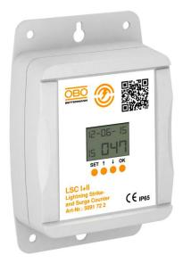
Le compteur d'impacts de foudre LSC I+II détecte les courants d'impulsion et les sauvegarde avec date et heure de manière durable. Ce contrôle permanent permet de déterminer si un éclair a frappé le système de protection contre la foudre. Si c'est le cas, une vérification du système doit être faite conformément à la norme NF EN 62305 (IEC 62305).
