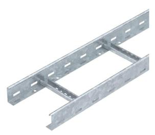
Echelle à câbles avec longeron latéral perforé d'une hauteur d'aile de 60 mm, avec échelons NS rivetés (profilé en C) ouverts vers le haut.
