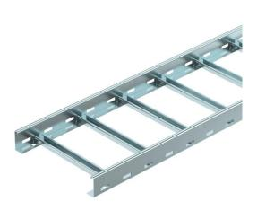
Échelle de câbles pour la pose horizontale de câbles et de conduits. Peut être employé comme structure porteuse normalisée pour le maintien de fonction selon DIN 4102 partie 12 Classes de maintien en fonction E30 à E90. Avec un échelon profilé en C riveté et ouvert en haut.
