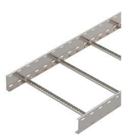
Échelle à câbles avec longeron latéral perforé d'une hauteur latérale de 110 mm, avec échelons rivetés à profilé en C ouvert vers le haut. L'échelle à câbles est livrée repliée.
