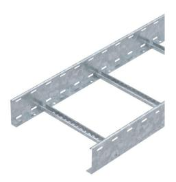
Échelle à câbles d'une hauteur d'aile de 110 mm avec échelons rivetés à profilé en C ouvert vers le haut. Longeron latéral enroulé pour le renforcement et la protection des bords. La fixation sur console s'effectue avec des pièces de serrage de type LKS 60/4. La fente de l'échelon mesure 16,5 mm. La bride de fixation correspondante est de type 2056.
