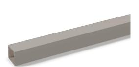
Goulotte de distribution LE pour le cheminement des câbles Socle de goulotte avec fond perforé pour le montage. Difficilement inflammable et auto-extinguible après retrait d'une flamme ardente. Effectuer des changements de direction avec les pièces de forme et obturer les extrémités de goulotte à l'aide des embouts.
