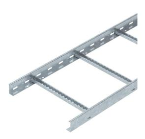
Échelle à câbles d'une hauteur latérale de 60 mm avec échelons soudés à profilé C30 ouvert vers le haut. Longeron latéral enroulé pour le renforcement et la protection des bords. La fixation sur console s'effectue avec des pièces de serrage de type LKS 40. La fente de l'échelon mesure 16,5 mm. La bride de fixation correspondante est de type 2056.
