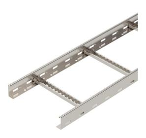
Échelle à câbles d'une hauteur d'aile de 60 mm avec échelons soudés à profilé C30 ouvert vers le haut. Longeron latéral enroulé pour le renforcement et la protection des bords. La fixation sur console s'effectue avec des pièces de serrage de type LKS 40. La fente de l'échelon mesure 16,5 mm. La bride de fixation correspondante est de type 2056.
