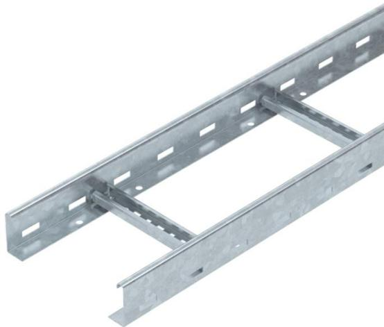
Échelle à câbles d'une hauteur latérale de 60 mm avec échelons soudés à profilé C30 ouvert vers le haut. Longeron latéral enroulé pour le renforcement et la protection des bords. La fixation sur console s'effectue avec des pièces de serrage de type LKS 40. La fente de l'échelon mesure 16,5 mm. La bride de fixation correspondante est de type 2056. Atténuation magnétique du blindage sans couvercle 10 dB, avec couvercle 15 dB.
