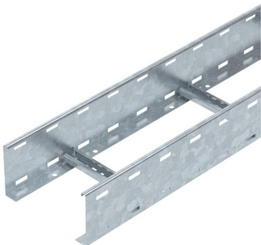
Échelle à câbles d'une hauteur d'aile de 110 mm avec échelons soudés à profilé C30 ouvert vers le haut. Longeron latéral enroulé pour le renforcement et la protection des bords. La fixation sur console s'effectue avec des pièces de serrage de type LKS 40. La fente de l'échelon mesure 16,5 mm. La bride de fixation correspondante est de type 2056. Atténuation magnétique du blindage sans couvercle 10 dB, avec couvercle 15 dB.
