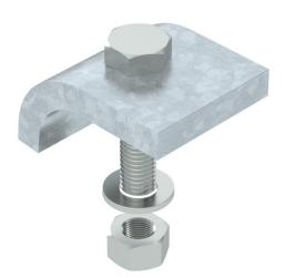
Crapaud de serrage type KWS avec vis à tête hexagonale pour la fixation directe de structures sur les collets de poutres métalliques. Le crapaud à vis doit être adapté à l'épaisseur de l'IPN correspondant.
