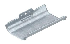
Les gouttières support de câbles sont destinées à une pose simple et rapide dans des zones n'offrant pas un espace suffisant pour montage de systèmes de support de câbles courants. Les gouttières support de câbles dispose d'une grande surface d'appui et de bords extérieurs arrondis pour protéger les câbles. Conformément à la norme DIN VDE 0298-300, ne pas dépasser un écart max. d'appui de 0,8 mm.
