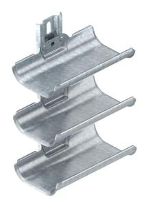
Les gouttières support de câbles sont destinées à une pose simple et rapide dans des zones n'offrant pas un espace suffisant pour montage de systèmes de support de câbles courants. Les gouttières support de câbles dispose d'une grande surface d'appui et de bords extérieurs arrondis pour protéger les câbles. Conformément à la norme DIN VDE 0298-300, ne pas dépasser un écart max. d'appui de 0,8 mm.
