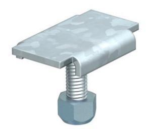
Pièce de serrage pour la fixation des équerres de montage MW 45 et MW 90 sur les chemins de câbles en treillis de type CGR. Avec écrou autobloquant dans M6.
