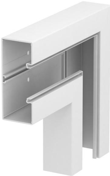
Angle plat pour un changement de direction des goulottes d'appareillages GK. Largeur de couvercle mm pour toute largeur de goulotte, ce qui évite toute utilisation de tronçons de couvercles perforés lors de l'utilisation de modules à encastrer. Utiliser exclusivement des appareils encastrables à faibles rayons de courbure.
