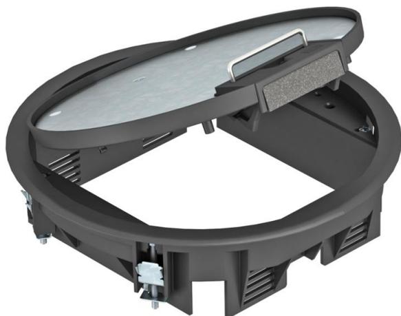
Boîtier de sol avec poignée étrier pour 6 appareillages individuels Modul 45 maximum sur 2 supports universels UT3, insertion dans les systèmes de goulottes et les faux plafonds en intérieur.
