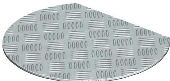
Plaque de finition pour une insertion affleurante dans des boîtiers de sol. Surface avec structure en tôle striée « Quintett ». Utilisation uniquement avec une plaque de finition intercalaire correspondante. Modèle ..R9/10 pour boîtiers de sol en polyamide, modèle ..RA9/10 pour boîtier de sol en fonte d'aluminium.
