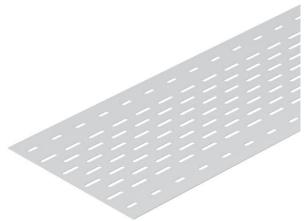
Tôle de fond à introduire dans les échelles à câbles. Pour la fixation dans des échelles à câbles longue portée, utiliser des vis à tête bombées avec écrou à rondelle sertie de type FR SB 6x30.
