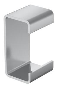
Entretoise à utiliser dans un montant en U. L'entretoise est systématiquement utilisée pour accroître la stabilité, afin que le montant ne soit pas déformé lors du serrage de la console à l'aide des vis à tête hexagonale.
