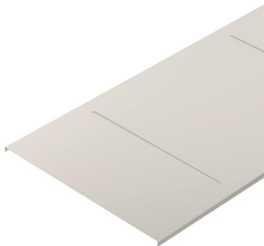
Couvercle encliquetable pour chemins de câbles en treillis. Protège les câbles et les lignes contre les dommages, la contamination et l'humidité venant d'en haut. Convient à l'industrie alimentaire ou chimique. Avec nervure horizontale à partir de 400 mm de largeur. Lors de l'utilisation de couvercles à l'extérieur, des mesures supplémentaires contre les influences du vent peuvent être nécessaires.
