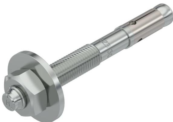
Boulon d'ancrage BZ3 pour ancrage de charges semi-lourdes et lourdes dans du béton fissuré ou non fissuré. Convient pour des charges admissibles élevées à de faibles entraxes et écartements entre les bords. À frapper.
