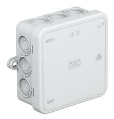
Type de protection IP55, tension nominale 690 V, section nominale 2,5 mm², 12 entrées pour diamètres de câble de 5 à 14 mm.
