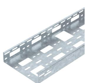
Canal AZ d'une hauteur d'aile de 50 mm. Atténuation magnétique du blindage sans couvercle 20 dB, avec couvercle 50 dB.
