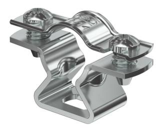
Collier d'écartement pour le montage de tubes et câbles au mur, au plafond et au sol. Avec partie supérieure autobloquante. Fixation par trou oblong. A partir de la taille 20 des colliers, convenant au montage avec cloueur ou pistolet de scellement.
